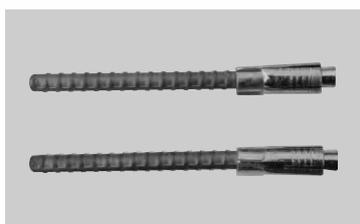
差筋突出長100mm。ブロック底面の穴に差し込み、ハンマーで打ち込んで固定させます。強打しすぎないようにご注意ください。
